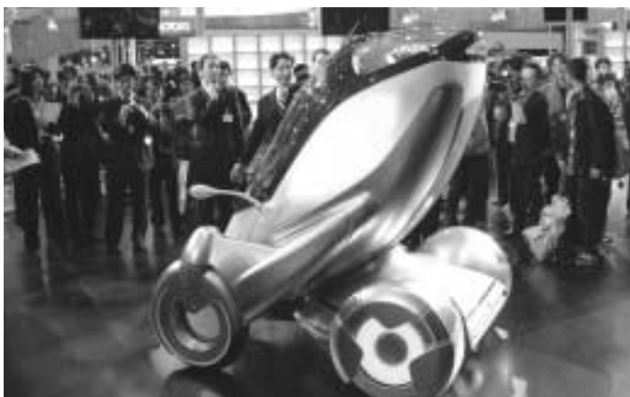
Le Toyota MP – « Mobilité personnelle » - un véhicule à une place utilisant la technologie de conduite par fil
